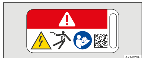
5. att. Bīrīnājuma zīme uz augstsprieguma komponentiem.
